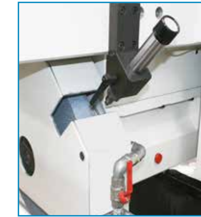
> ADJUSTABLE WHEEL DRESSER, OPTIONAL FOR THE MODEL RT700, STANDARD FOR RT1000 Diamantatore regolabile posizionato sulla testa, optional per il modello RT700, standard per il modello RT1000
