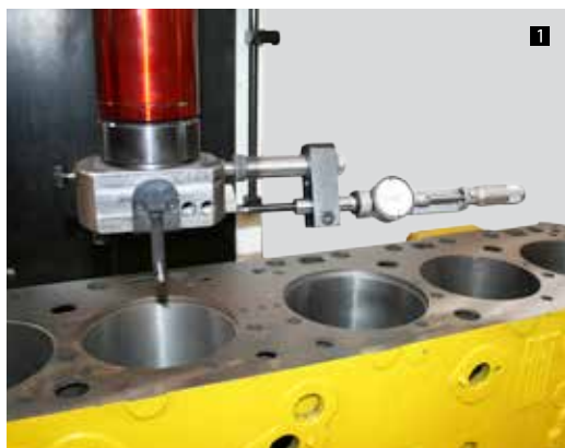
1 AZ834 TOOLS MEASURING DEVICE WITH INSTRUMENT AZ834 Dispositivo misuratore utensile con strumento.
