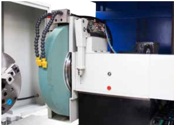
La testa portamola si muove sugli assi X e Z con viti a ricircolo di sfere e guide lineari. La posizione della testa è controllata mediante rotazione da encoder lineare a ciclo chiuso. La testa portamola può avere differenti configurazioni :
