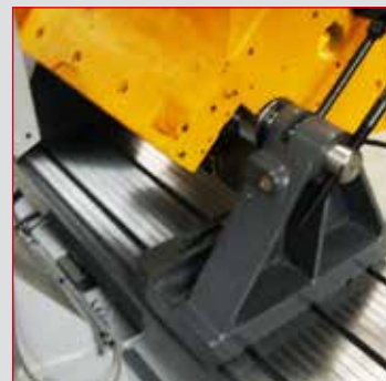
4. 45° REFERENCE SQUARE INCLUDED WITH AZ601 Squadra a 45° inclusa con AZ601 5. AZ601.02 REFERENCE SQUARE 30°- 60° FOR AZ601 AZ601.02 Squadra di riferimento 30°-60° per AZ601
